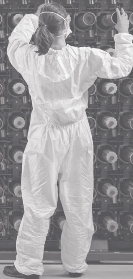
*Ajout des bobines de fibres de carbone sur le métier à tisser.*
